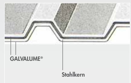
Aufbau GALVALUME®-beschichtetes Dachelement
